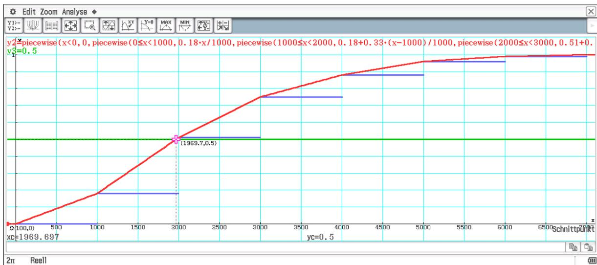
Quantilberechnung (z.B. Median) über den Schnittpunkt der Geraden  $y = 0.50$  (50%-Niveau) mit dem Summenpolygon.
