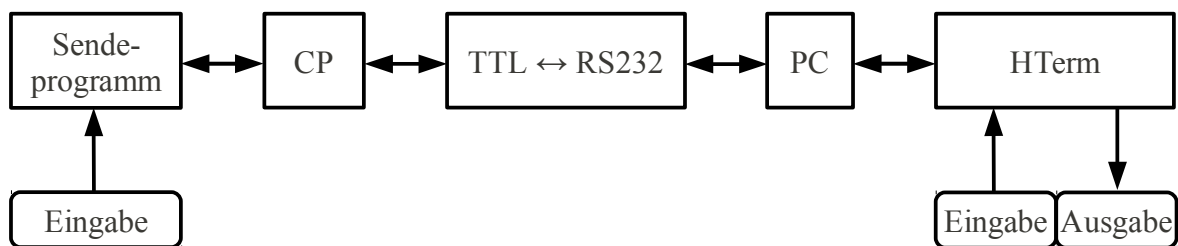
Zeichnung 1: Kommunikationsschema von ClassPad zum PC
